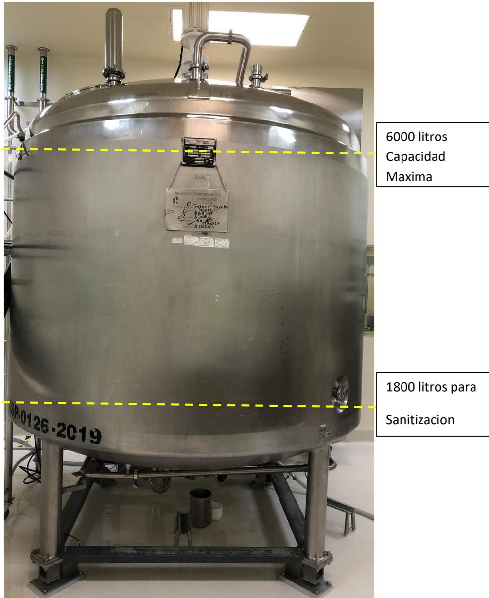
Figura 4.4. Foto del Tanque de Fabricación No. 4. Representación de capacidad de agua purificada
